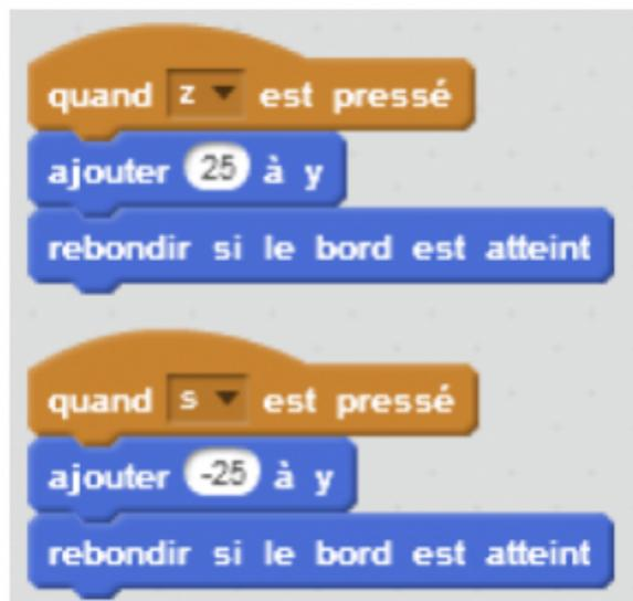
**Lorsque la touche « z » est pressé**, le personnage se déplace de 25 sur l'axe des ordonnées Y. **Lorsque la touche « s » est pressée**, le personnage se déplace de -25 sur l'axe des ordonnées Y. Dans les deux cas, s'il touche le bord, il rebondit, c'est-à-
