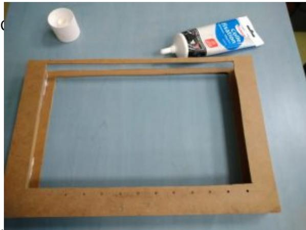
Les 12 trous vers le bas avec l'espacement de 4 cm avant les trous, vers la gauche.
